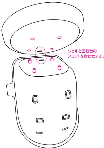
② 回転台の底面から太ボルト(短)を締めて、シェルを回転台に固定します。
