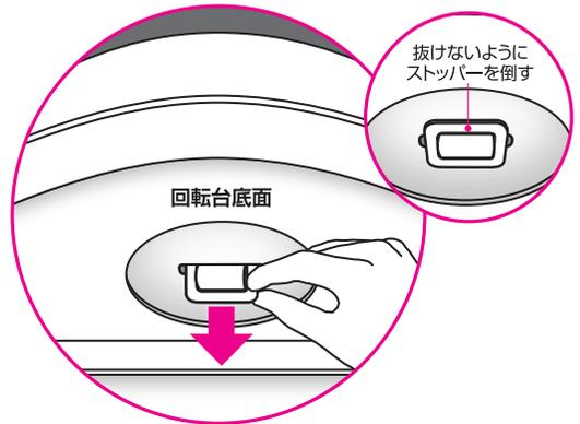
④座面側から股ベルトを引っ張り、ストッパーが抜けないことを確認し、シートカバーとハーネスを整えてください。
