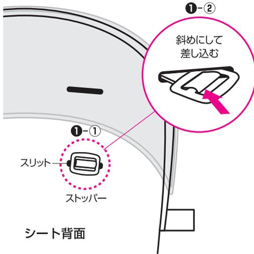
② シート前面に抜き出した肩ベルトのストッパーを斜めにして上のスリット(カバーとシェルの両方)に差し込み、シート背面から抜き出します。最後にストッパーを立ててください。
