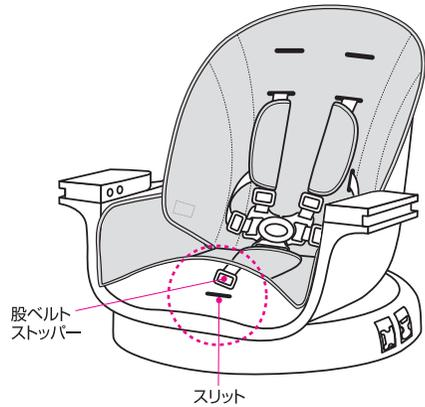
②股ベルトのストッパーを、シェルのスリットに真っすぐに差し込みます。
