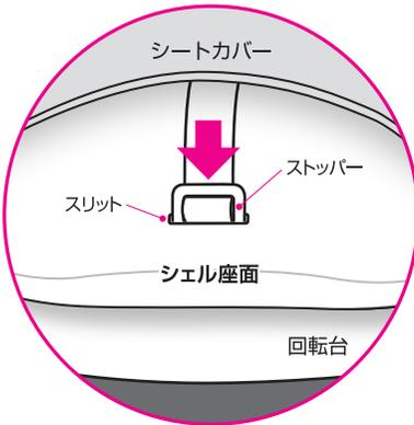
③回転台の底面にある楕円形の穴から指を入れ、股ベルトのストッパーをスリットから抜き出し、ストッパーを倒します。
