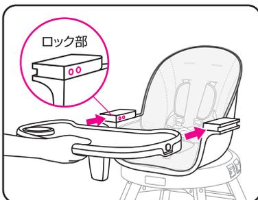
ロックレバーを握った状態で、左右のひじ掛けにテーブルを差し込み、レバーをゆるめてスライドさせてゆくと、ロック部で固定されます。
