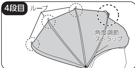
角度調節ストラップを3段階目のループに通し、スナップボタンで留めます
