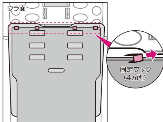
シートパッド背面の固定フックを外し、シートパッドを上からめくり取ります。取り付けは腰部分からかぶせます。
