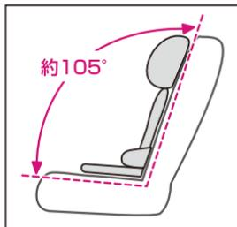
車のシートがリクライニングできる場合、シートを極端に寝かせた状態で使用されますと衝突時に本来の性能が発揮できません。必ずシート角度105°以内でご使用ください。
