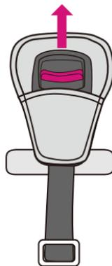
①座面を裏返し、左図のように股ハーネスの留め具を、スロットから座面上面へ抜くとバックルが外せます。
