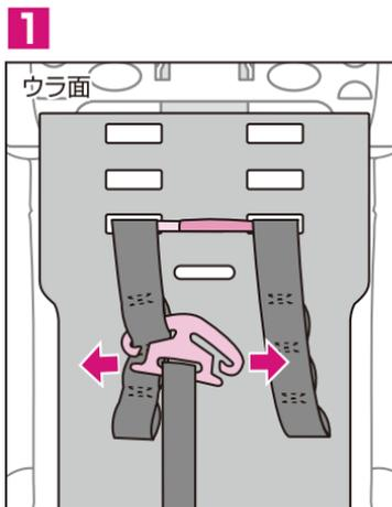
背もたれ背面の連結金具から左右のハーネスベルトを抜いて外します。
