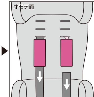
①バックルを外し、背面の連結金具から左右の肩ハーネスを抜いて外します。
