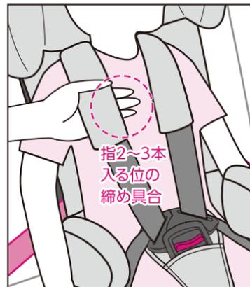
お子さまに装着し、ハーネスベルトを締め込んだ際の締め具合は、身体とベルトの間に指が2~3本入る位が目安です。
