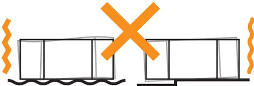
パネルが外れたり、サークルが動いたりするなど、重大な事故の原因となります。必ず平らで水平な場所に設置してください。
