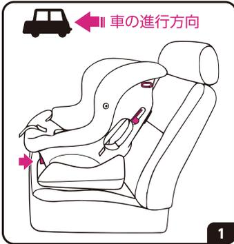
チャイルドシートを車の進行方向前向きで座席の背もたれに接するように設置します。リクライニングレバーを引いて、リクライニングポジションを調節してください。チャイルドシートのリクライニングがロックされ動かない事を必ず確認してください。
