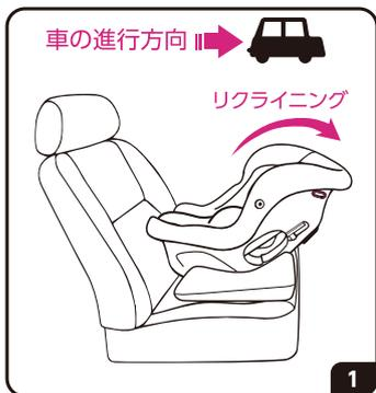
チャイルドシートを車の進行方向後ろ向きに座席の背もたれに接するように設置します。リクライニングレバーを引いて3段目のリクライニングポジション(一番倒れたポジション)にセットします。
