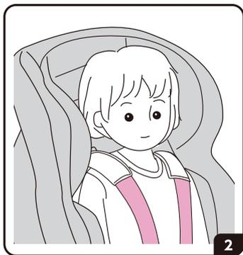
お子さまの背中がシートにピッタリ着くようにチャイルドシートに深く座らせ、左右の肩ベルトに腕を通してください。このときハーネスベルトを踏まないように気を付けてください。
