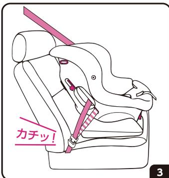
シートベルトを車のバックルに「カチッ!」と音がするまで差し込みます。
