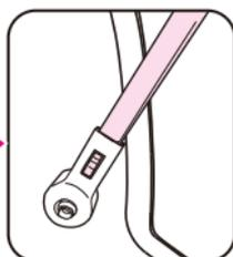
幌を後ろ側からかぶせます。幌骨の先端を、左右の幌用ヒンジにしっかりロックされるまで差し込みます。
