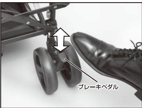
後輪のブレーキペダルを踏み込むと、ブレーキが掛かります。ペダルを押し上げるとブレーキが解除されます。
