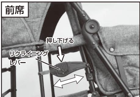
【倒す時】本体左右についているリクライニングレバーの中央部を同時に押し下げながら倒すと、背もたれの角度を調節できます。(3段階)
