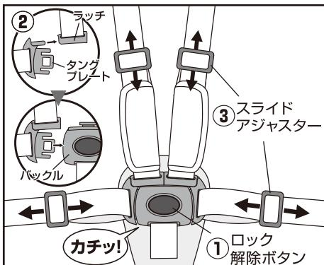
①バックル中央のロック解除ボタンを押すと、ハーネスベルトが外せます。
