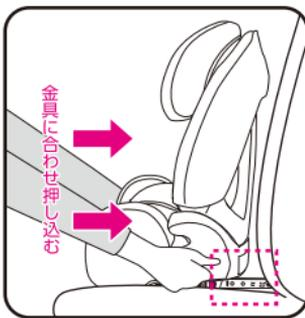
ISOFIXコネク터를車のISOFIX取付金具の位置に合わせ、チャイルドシートを両手で軽く押し込みISOFIXコネク터를ロックします。ISOFIXコネクターが正しくロックされると図のようにインジケータの表示が赤色から緑色に変わります。
