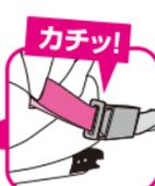
お子さまを背中がシートにピッタリつくようにチャイルドシートに深く座らせ、シートベルトを引き出し、パツルに「カチッ!」と音がするまで確実に差し込みロックします。
