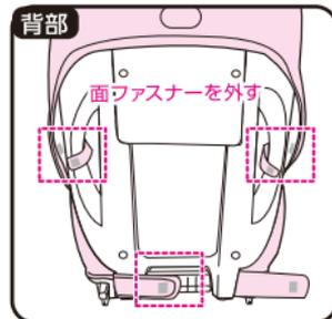
背もたれカバー左右側面と座面カバーの面ファスナーとゴム紐を外します。
