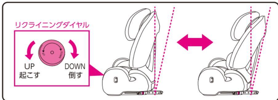
リクライニングダイヤルは、右に回すと背もたれが倒れ、左に回すと起き上がります。取り付け後にリクライニングを調節した場合は、必ず取り付けをやり直してください。
