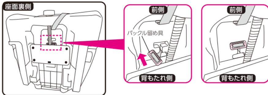
座面裏側のバックル留め具を立てて、H型の溝に沿って前後に移動させ、位置を調節してください。
