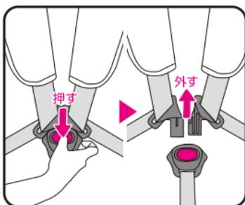
バックル解除ボタンを下に押し、ロックを解除します。
