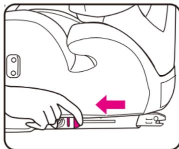
左右のISOFIXコネクタースイッチを押しながら、チャイルドシートの座面下にISOFIXコネクターをスライドし、収納してください。
