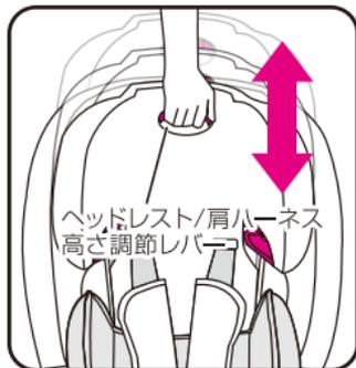
ヘッドレストカバー内側の、ヘッドレスト/肩ハーネス高さ調節レバーを引き上げながら、ヘッドレストを上下することで肩ハーネスの高さを調節できます。お子さまの体格に合わせて適切な高さに調節してください。
