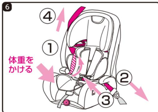
体重をかけながら、車のシートベルトを左図の①→②→③→④手順で矢印の方向に引き絞り、たるみをなくしてください。
