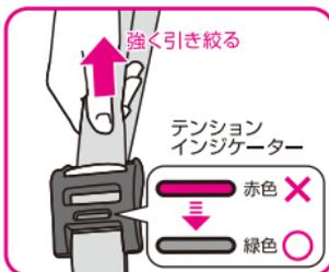
TOPテザーベルトを接続した後、テンションインジケーターが緑色に変わるまでTOPテザーベルトを強く引き絞ります。
