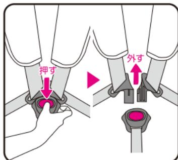
バックル解除ボタンを下に押し下げロックを解除します。
