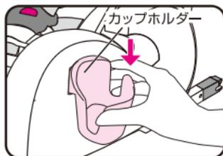
図のように、座面左右にあるカップホルダー取付用ブラケットにカップホルダーを上から差し込み取り付けます。取り外す際は、カップホルダーを上方向にスライドさせて取り外します。
