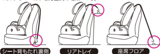
TOPテザーベルト長さ調節アジャスターのベルトロック解除ボタンを押しながらベルトを伸ばし、TOPテザーベルトフックを車のTOPテザー取付金具に接続します。
