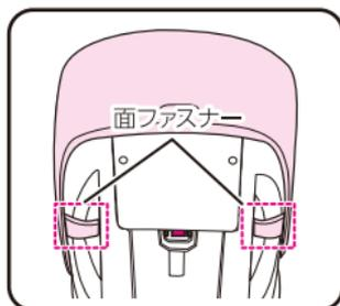
背もたれカバー左右のベルト通し部を留めている面ファスナーとゴム紐を外し、背もたれカバーを取り外してください。
