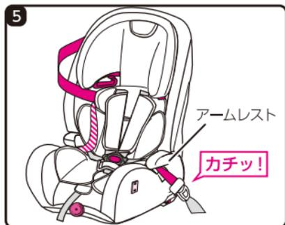
シートベルトを車のバックルに「カチッ」と音がするまで差し込み、確実に固定してください。
