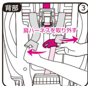
①のようにたわませながら本体背面のリアカバーを外し、②下部より肩ハーネス連結金具を引き出し、③左右の肩ハーネスを取り外し、背もたれ前側より抜き取ります。
