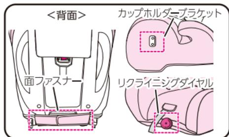
座面裏側で留めている面ファスナーと、リクライニングダイヤル・カップホルダーブラケットの部分を外しながら座面カバーを取り外してください。
