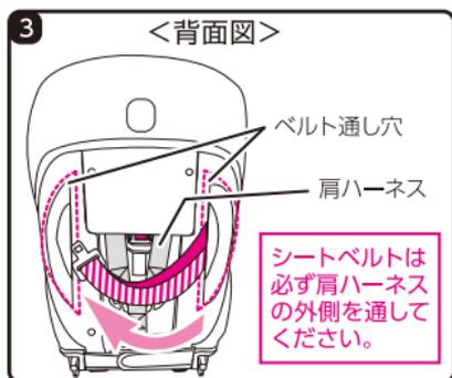
背もたれ背面からシートベルトを引き出し、反対側のベルト通し穴に通します。
