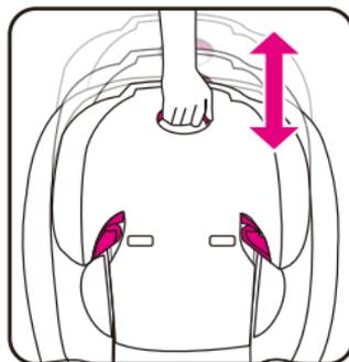
ヘッドレストカバー内側の、ヘッドレスト/肩ハーネス高さ調節レバーを握り、お子さまの体格に合わせて適切な高さに調節してください。
