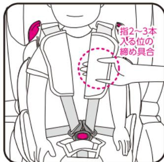
ハーネスベルト長さ調整ストラップを引き、お子さまの身体に合わせて肩ハーネスの長さを調節してください。
