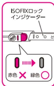
インジケータの表示が緑色に変わったことを確認した後、チャイルドシートが車の座席の背もたれに接触する様に両手で強く押し込みます。
