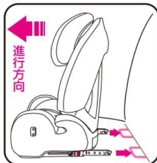
チャイルドシートを車の進行方向前向きに設置してください。
