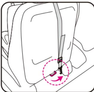
TOPテザーベルト長さ調節アダプターのベルトロック解除ボタンを押し、ベルトを緩めTOPテザーベルトフックを外します。
