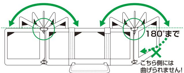
ジョイントロック(左右)のロックを解除し、上側のパネルを少し持ち上げながらフラップパネルの角度を調節し、再びジョイントを固定してください。
