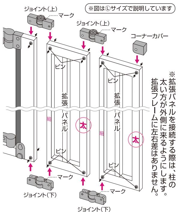
ドアパネル / 拡張フレーム・パネルの上下の角にある両面のピンを押し込みながら、ジョイントの穴をピンに合わすようにはめ込むと固定できます。
