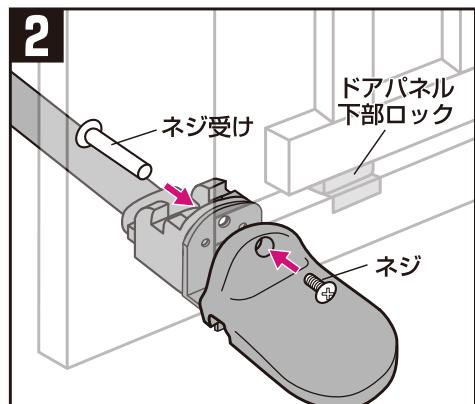
①ドアパネル【子ども側】下部のアンカー(左右)にスタンドフレームの両端をさし込み、
