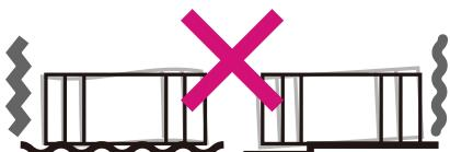
製品が傾いたり動いたりすると、重大な事故の原因となります。必ず平らで水平な場所に設置してください。
