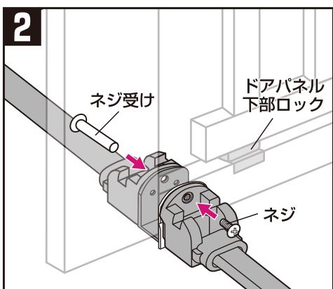
①ドアパネル下部のアンカー(左右表裏)にスタンドフレームの両端をさし込みます。
