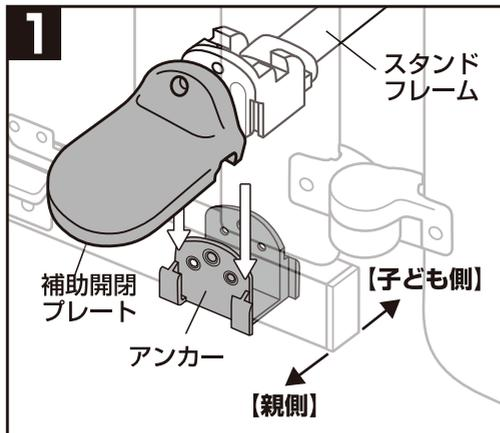
**1** ドアパネル【子ども側】下部のアンカー（左右）にスタンドフレームの両端をさし込み、【親側】のアンカー（ロック側）には補助開閉プレートをさし込みます。
