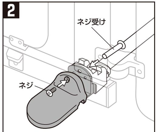
**2** 左右のネジ穴にネジ受けをさし込み、反対側にネジをさし込みます。2本のプラスドライバーを使用し、ネジを固定してください。
