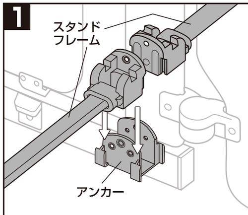
**1** ドアパネル下部のアンカー（左右表裏）にスタンドフレームの両端をさし込みます。
