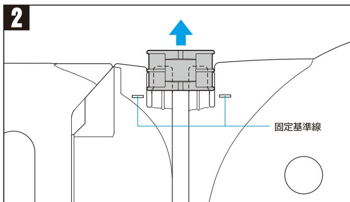
● 残り7カ所の上部ジョイントを、固定基準線の上まで引き上げます。
