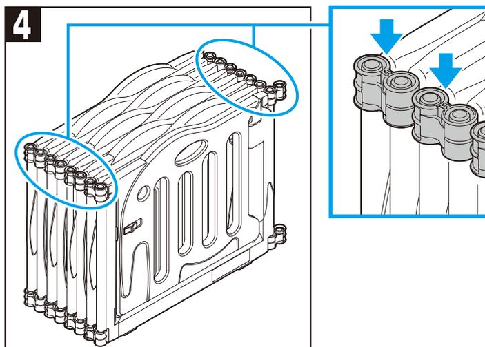
● 折りたたみ後、すべての上部ジョイントを最後まで差し込み開かないように固定します。
