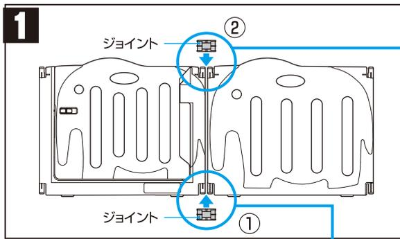
●2枚のパネルをジョイントで接続します。
