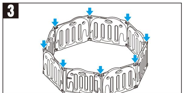
●設置場所での形状が決まったら、上部のすべてのジョイントを最後まで差し込み角度を固定してください。
