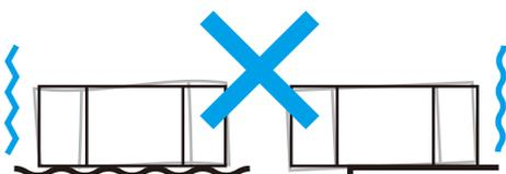
パネルが外れたり、サークルが動いたりするなど、重大な事故の原因となります。必ず平らで水平な場所に設置してください。
