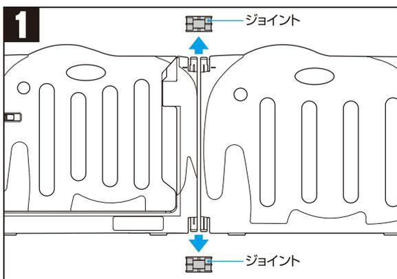
● サークル1カ所の上下ジョイントを外します。
