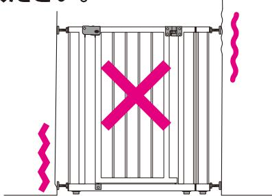
ゲートが倒れたり、扉が完全に閉まらないなど、重大な事故の原因となります。確実に固定できる場所に設置しなおしてください。
