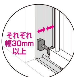
図3：取付ボルトのスペースがあるサッシ枠
