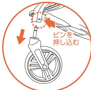
ピンを押し込み、前輪を取り外します。
