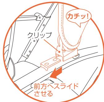
本体フレームの日よけコネクターに、日よけのクリップを前方へスライドし、「カチッ!」と音がするまで差し込みます。
