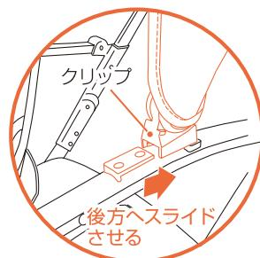
日よけ左右のクリップを後方へスライドさせ、取り外します。
