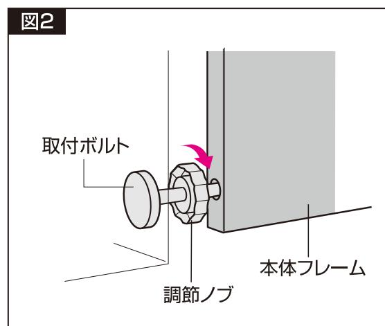
3. 取付ボルトと壁が接する場所に、補助ソケットを取り付けると、より強く固定できます。
