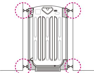
ご使用中に取り付けボルトがゆるんでくる場合があり、事故の原因となります。常に、ゲートが正しく取り付けられているか確認してください。
