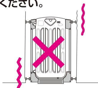
ゲートが倒れたり、扉が完全に閉まらないなど、重大な事故の原因となります。確実に固定できる場所に設置しなおしてください。
