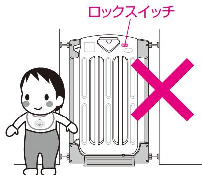
1. 取り付ける場所に本製品を合わせ、本体を支えながら上部の調節ノブ(左右2箇所)を締めつけ、仮留めの状態にします。下部の調節ノブは同じ要領で左右均等にしっかりと固定してください。(図1)
