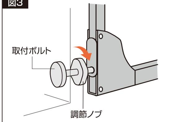
4. ゲイトが壁面と床面に対して直角であることを確認し、仮留めにしていたすべての調節ノブをしっかりと締めつけてください。特に下部の調節ノブはしっかりと締めつけ、固定してください。
