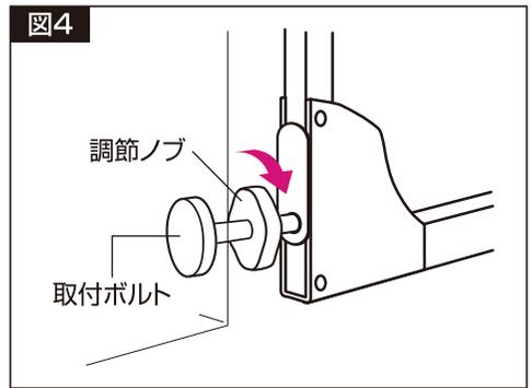
5. ゲイトが壁面と床面に対して直角であることを確認し、仮留めにしていたすべての調節ノブをしっかりと締めつけてください。特に下部の調節ノブはしっかりと締めつけ、固定してください。
