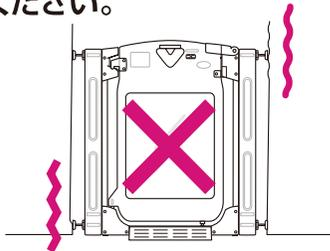
ゲイトが倒れたり、扉が完全に閉まらないなど、重大な事故の原因となります。確実に固定できる場所に設置してください。
