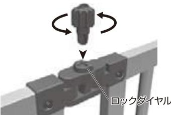
ロックダイヤルを時計逆回りに回すとジョイントのロックが解除されます。
