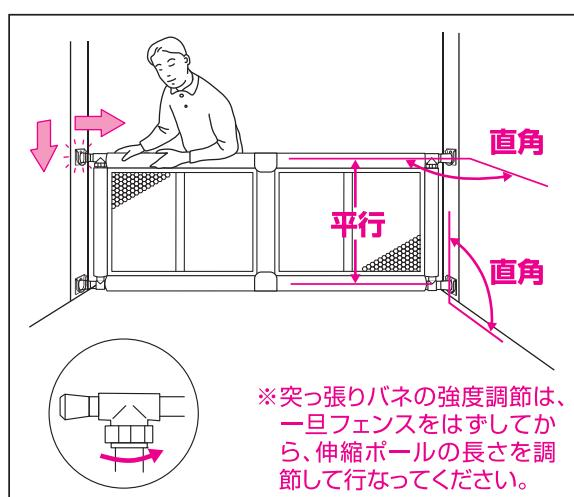
※突っ張りバネの強度調節は、一旦フェンスをはずしてから、伸縮ポールの長さを調節して行なってください。
