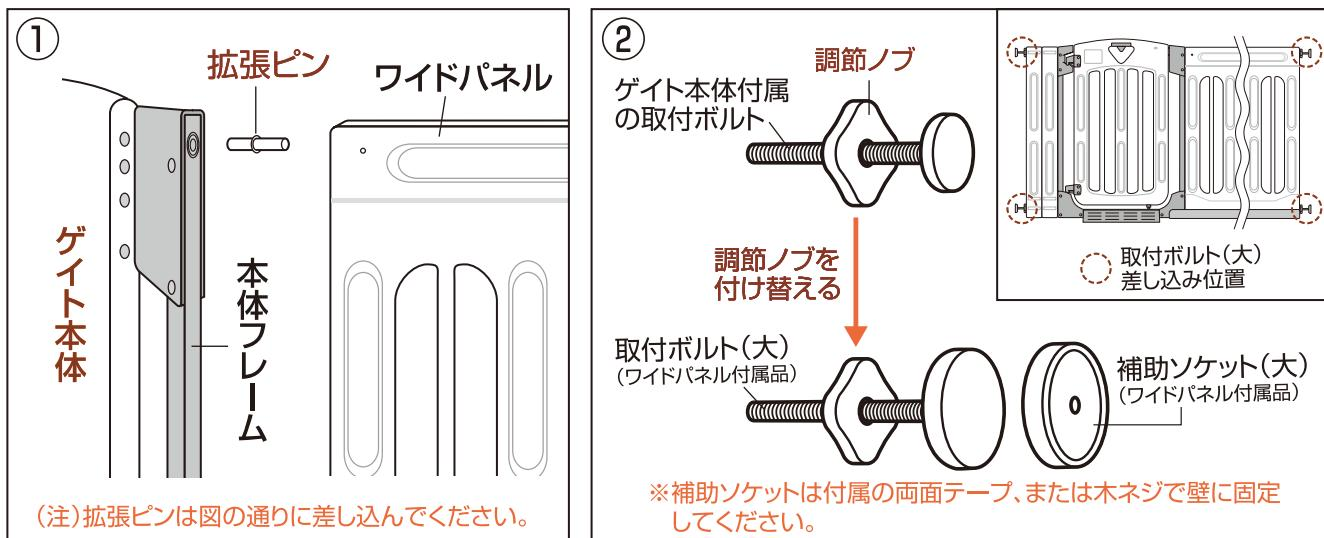
2. ●取り付ける場所に本製品を合わせ、本体を支えながら上部の調節ノブ(左右2箇所)を締めつけ、仮止めの状態にします。下部の調節ノブは同じ要領で左右均等にしっかりと固定してください。
