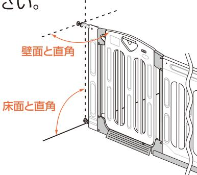
⚠ 本体フレームと専用ワイドパネルが隙間なく、平行になるように取り付けてください。
