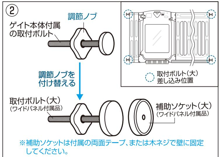
2. ●取り付ける場所に本製品を合わせ、本体を支えながら上部の調節ノブ(左右2箇所)を締めつけ、仮止めの状態にします。下部の調節ノブは同じ要領で左右均等にしっかり固定してください。
