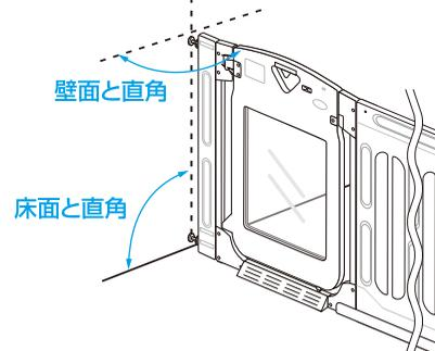
⚠ 本体フレームと専用ワイドパネルが隙間なく、平行になるように取り付けてください。
